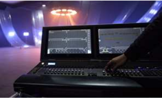
内置Lumenradio芯片，可实现CRMX无线操控，精准、稳定控灯。
