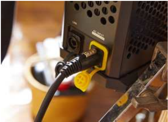
纽崔克插头，一键按压拔插，快捷可靠。
